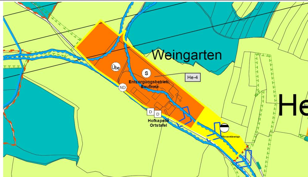
Darstellung einer geplanten Sonderbaufläche entsprechend dem in Aufstellung befindlichen Bebauungsplan Nr. 161 „SO – Entsorgungsbetrieb, Bau-firma, Containerdienst und betriebsbezogenes Wohnen“. Die bereits bestehende Niederschlagswasserbehandlungsanlage im Süden der Fläche He-4 wird als Fläche für die Abwasserbeseitigung dargestellt.
